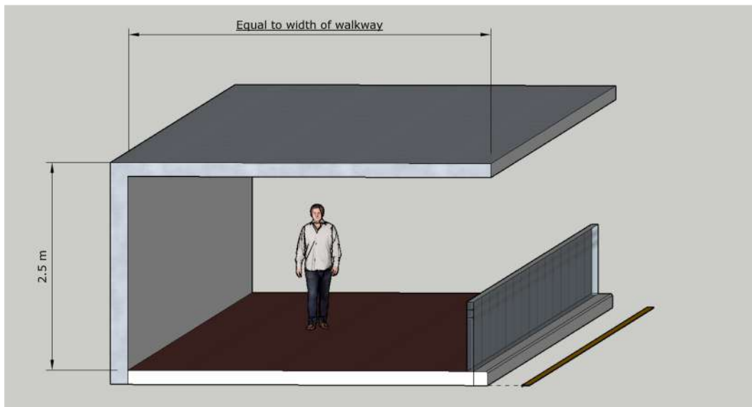
Rajah 4.7: Gambar rajah skematik bumbung keselamatan di atas laluan pejalan kaki/lorong basikal
