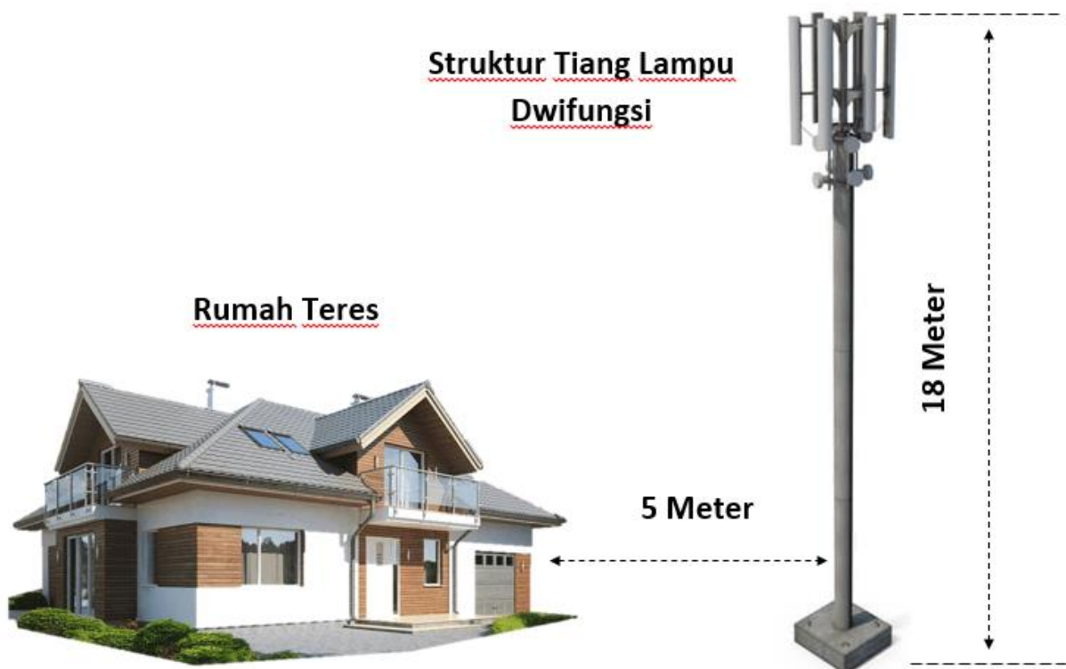
Contoh jarak antara rumah teres dengan struktur tiang lampu dwifungsi
