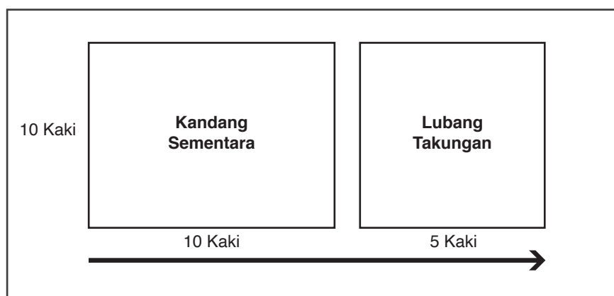
Rajah 1: Arah pancutan air basuhan dari kawasan kandang sementara perlu terus ke dalam lubang takungan. Semasa menutup lubang takungan, kapur perlu ditaburkan sebanyak 2 lapisan.
